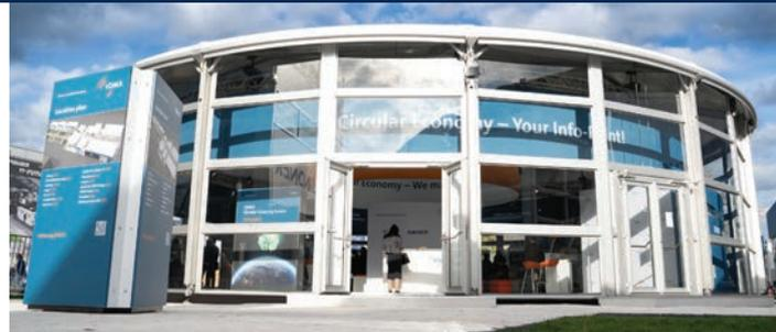
Die Alure Globe Dome hat eine freie Spannweite von 20 Metern. Die Seitenwand ist aus drei oder vier horizontalen Platten aufgebaut. Dadurch kann diese einzigartige Struktur mit Seitenwandhöhen von 3,85 oder 5 Metern gebaut werden. Die freie Innenhöhe in der Mitte der Konstruktion beträgt somit 6,5 oder 7,8 Meter. Diese einzigartige Höhe bietet umfangreiche Möglichkeiten für die Einrichtung der Struktur. Der Alure Globe Dome kann auch mit einem überhängenden Giebel von 2,2 Metern gebaut werden.
